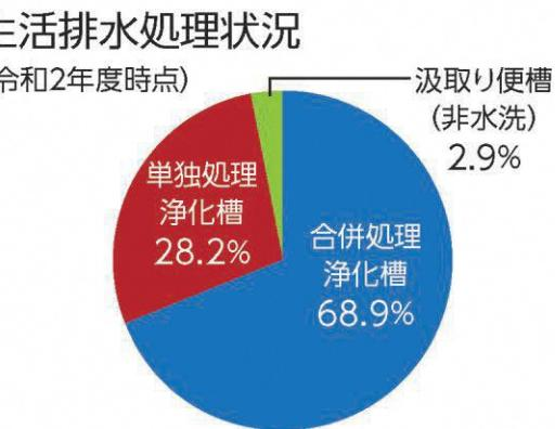
合併処理浄化槽では、水洗トイレ、台所、洗濯など生活排水全般を処理してから放流されますが、単独処理浄化槽では、水洗トイレの水だけを処理するため、台所や洗濯の排水はそのまま河川等に放流されることになります。
