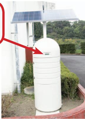
国では、福島県内の学校や公園等に通信タイプの空間線量計を設置し、インターネット回線によりデータセンターを通して、リアルタイムで放射線量をモニタリングできるシステムを構築しています。町内の学校等では10月から設置が進められ、12月までに町内33か所にリアルタイム線量測定器またはモニタリングポストが設置されます。
