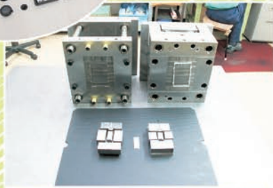
▲同社の金型によって成形された製品(上) 生産されたプラスチック金型(下)
