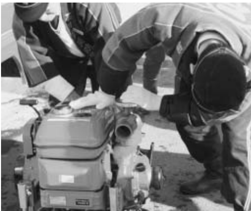
万が一に備え消防設備の点検が10日に1度ほど実施される
